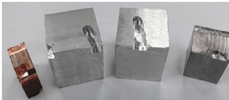
圖 8 虎鉗鬆動造的工作件受損狀況
