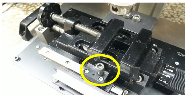
圖 8 虎鉗鬆動造的工作件受損狀況
