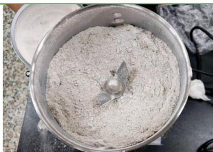
圖 1：使用研磨機研磨牡蠣殼
