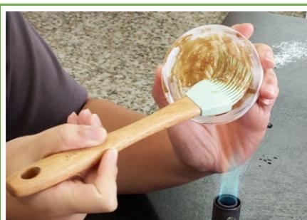
圖 6：把薄膜塗料塗在培養皿裡
