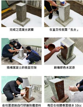
塗料測試2 • 防霉薄膜塗料測試
