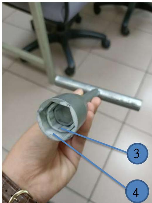
●圖 16：伸縮 T 型套筒扳手前端
