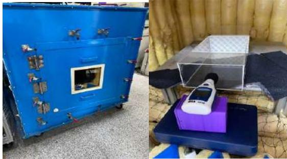
圖 3 噪音實驗設備之無響箱及箱內量測圖
