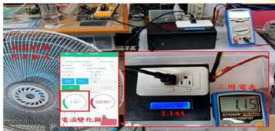
▲電力監控校正電流測試
