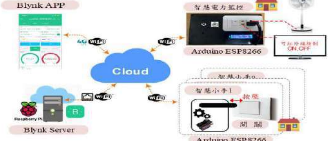
▲智慧電力監控系統架構
