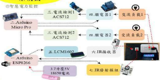
▲智慧電力監控系統架構
