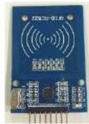
RFID-RC522模組，本專題主要使用此RFID模組安裝於智慧拖鞋底部，並將大量RFID卡片鋪於木製地板下面，透過與APP的整合就可以達到室內精確定位的效果。
