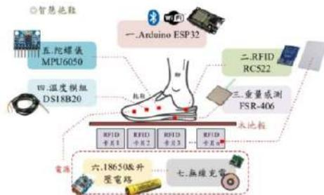
▲圖 3、智慧拖鞋系統架構
