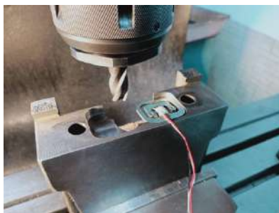
圖 14 荷重元的凹槽空間
